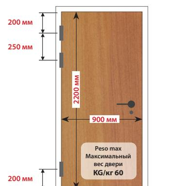
Porta con 2 cerniere e con 3 cerniere. Il peso della porta si intende uniformemente distribuito e l'installazione delle cerniere eseguita a regola d'arte e attenendosi alla scheda tecnica.
